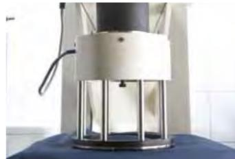
**WATERPROOFNESS TEST (HYDROSTATIC HEAD TEST)**
